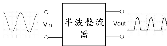
圖 3 經過一個二極體所產生的半波波形。
